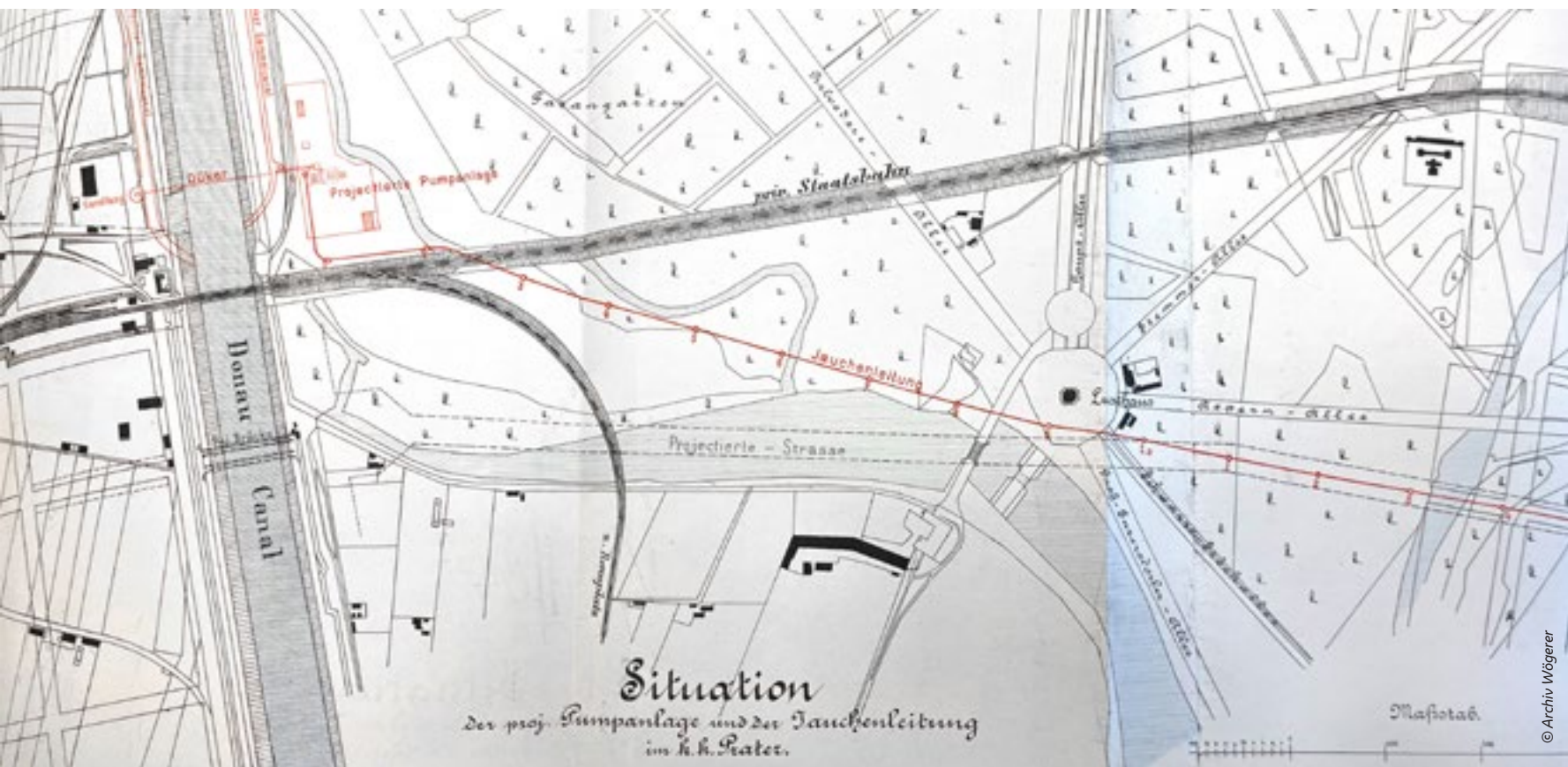
Beginn des Verlaufs der „Jauchenleitung“ zur Einleitung des Wiener Abwassers in den Podhagskyschen Kanal (1894)
